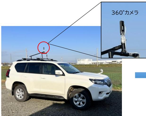
①ダンプトラックの運転目線に合わせて360°カメラを取り付け
