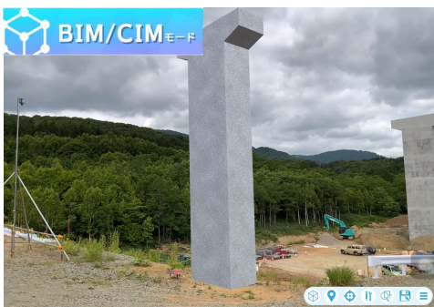
完成形状モデルの確認(橋脚)
