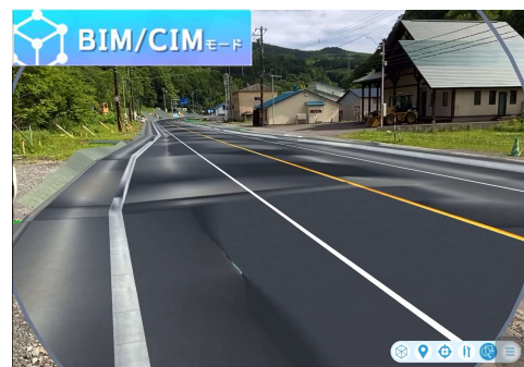
完成形状モデルの確認(道路)
