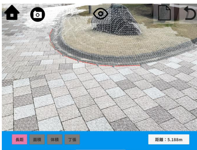
曲線部の計測例
