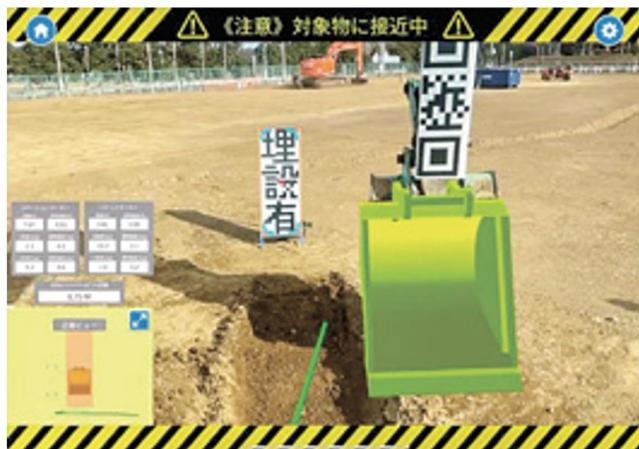
ARによる自機のバケットと地下埋設物のCIモデルを見ながら安全に作業できる
