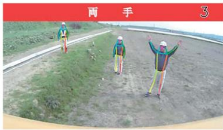
AIが合図者のジェスチャーを検知 (運転席のディスプレイ)
