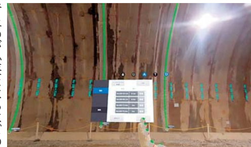
CIMモデルを重ねたXRゴーグル上の画面に計測位置と計測結果を表示
